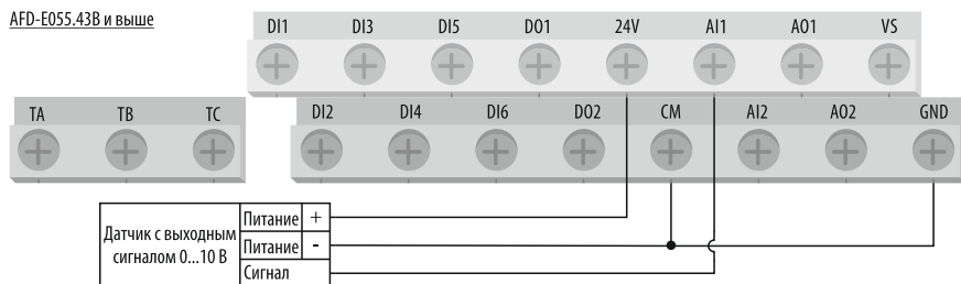
Рисунок 43 – схема подключения датчика с аналоговым выходным сигналом 0...10 В (питание от внутреннего источника питания 24 В).
