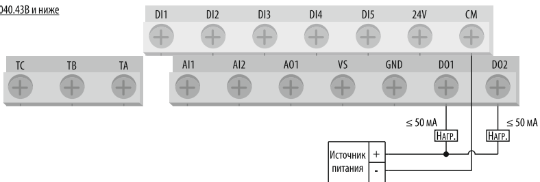
Рисунок 47 – схема подключения нагрузки к транзисторному выходу (питание от внутреннего источника питания 24 В).
